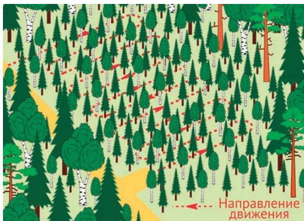
Рис. 2.25 Технологические схемы работы кусторезом [41]
