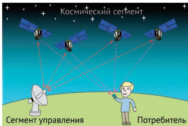
Рис. 3.1 Сегменты навигационных систем ГЛОНАСС и GPS
