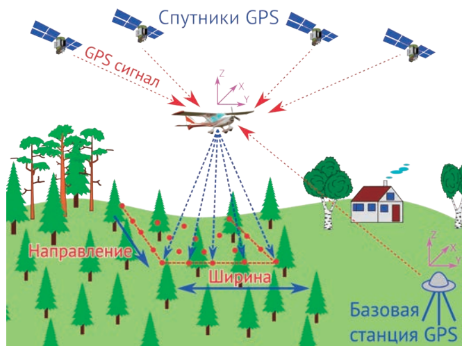
Рис. 3.4 Лазерное сканирование поверхности земли
