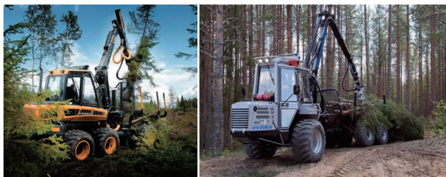
Рис. 2.30 Харвардер на заготовке тонкомерной древесины:
