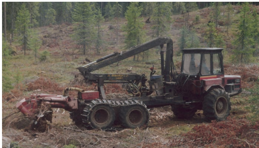
Рис. 1.15 Обработка почвы лесной бороной ТТС-Дельта (фото А. И. Соколова)
