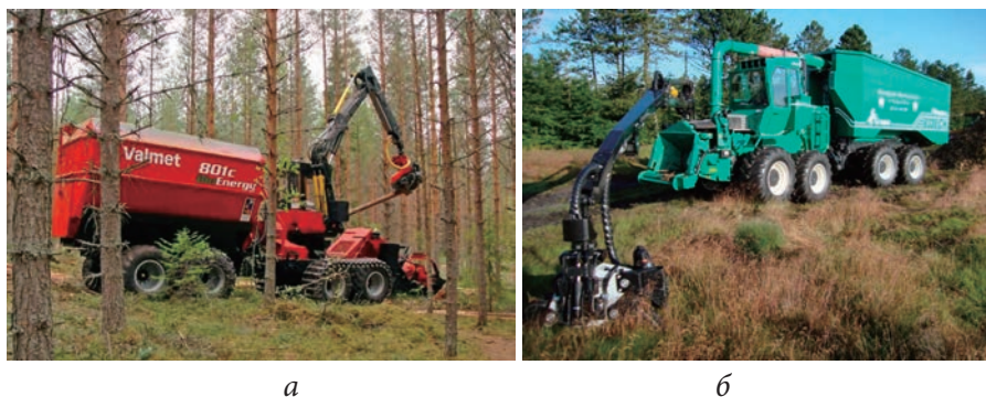
Рис. 2.32 Харвестер с рубильным модулем: а — Valmet 801 C Bio Energy Chipper [65]; б — Silvatec 878 CH [66]
