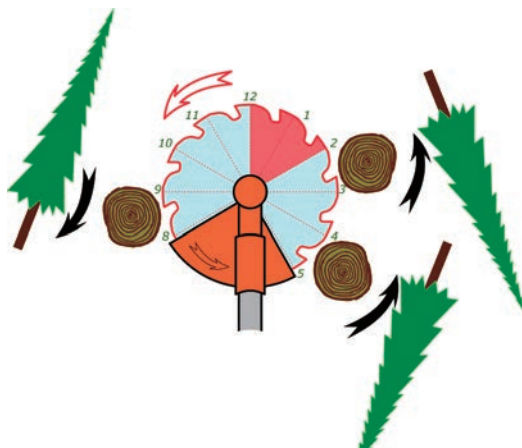
Рис. 2.26 Направленная валка деревьев мотокусторезом
