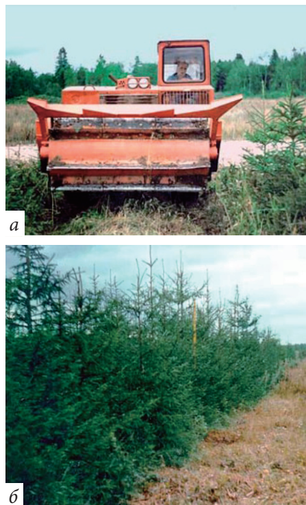
Рис. 2.34 Каток-осветлитель КОК-2: а — общий вид [16]; б — лесные культуры после работы катка [16]
