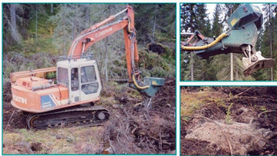
Рис. 1.16 Обработка почвы на вырубке с одновременной посадкой сеянцев лесопосадочной машиной (фото А. И. Соколова)
